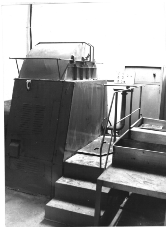
Рис. 4. Общий вид центробежно-планетарного станка для объемной обработки деталей
